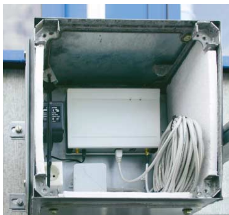
Der Schaltkasten ist mit etwas Styropor isoliert. So soll die Verlustwärme des Access Points die Temperatur im Kasten auch im Winter über dem Gefrierpunkt halten. Das DSL-Modem steckt in einem zweiten Kasten im Gebäudeinneren.
